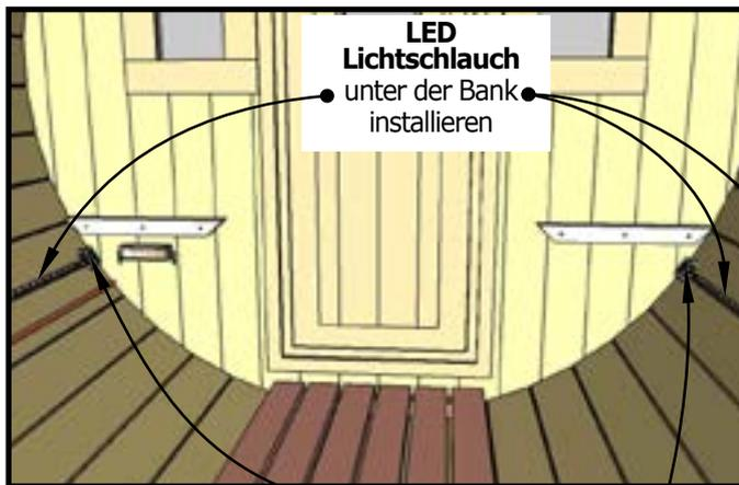
LED Lichtschlauch unter der Bank installieren
