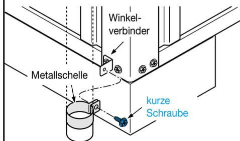
Die Fallrohrschele dann an der mittleren und zum Schluss an der unteren Aufnahme aus Metall am Eckpfosten fest verschrauben.
