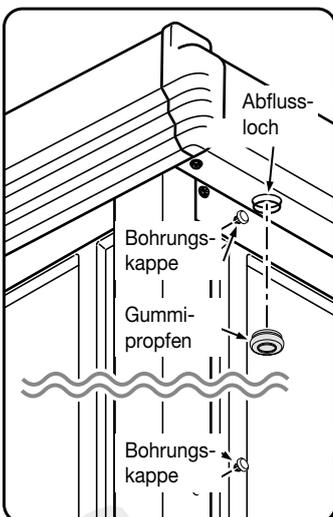
Die weitere Öffnung am Abfluss der Dachrinne, an die kein Fallrohr angeschlossen wird, wird mit einem großen Gummi-propfen verschlossen. In die Bohrungen am Eckpfosten (Oben und Mitte) die Bohrungs-kappe einstecken.
