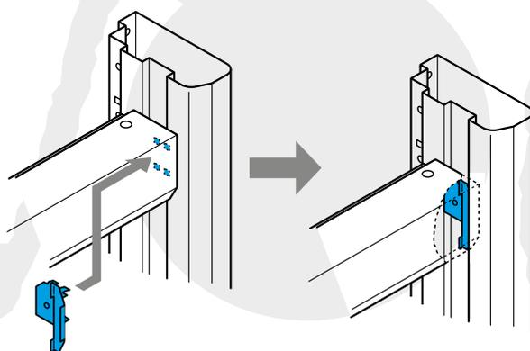
3. Die Frontblende rastet genau ein. Zum Schluss wird die Frontblende fest verschraubt.
