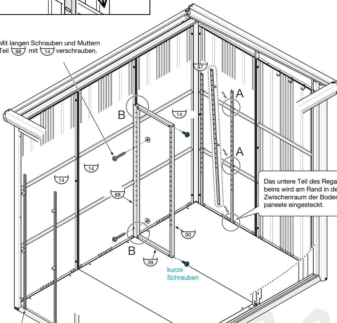
Das untere Teil des Regalbeins wird am Rand in den Zwischenraum der Bodenpaneele eingesteckt.
