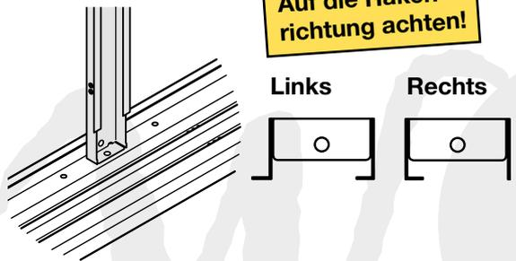
**Nach links öffnende Tür:** Bei der Montage wird das Oberteil des Pfostens für die Öffnung der Tür nach links umgedreht und nach der mittleren Bohrung des vorderen Bodenrahmens 01 ausgerichtet.
