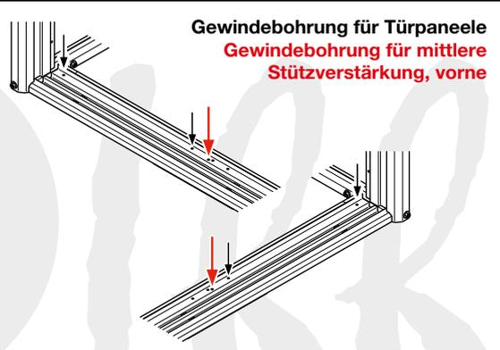
Die dritte Gewindebohrung, vom Eckposten ausgehend, wird für die Ausrichtung verwendet.
