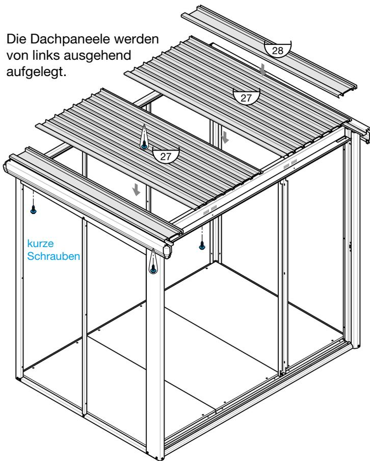
**A** Pro Dachpaneele (27) wird eine Tüte der Schneestopper benötigt. Pro Tüte gibt es einen Schneestopper mit Kleber auf der Rückseite. Ziehen Sie den Film ab und kleben Sie diesen zwischen den Pfosten, wo keine Verstärkung vorhanden ist, an. Für die kleinen Dachpaneele (28) wird kein Schneestopper verwendet.
