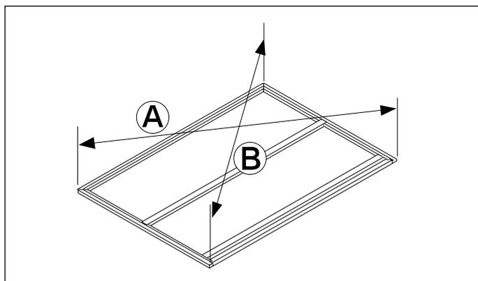
*Die Diagonalen A und B müssen gleich lang sein, um ein gleichförmiges Rechteck zu erhalten.*
