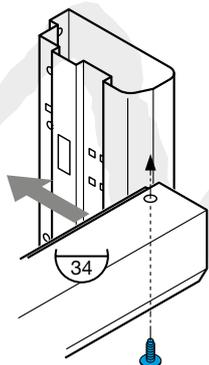
2. Dann werden die Metallhalterungen in die Vierercköffnungen des mittleren Pfostens für vorne gesteckt.
