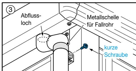
Die Fallrohrschele am Fallrohr einführen. Die beiden Querrohre samt des mittigen Verbindungsstückes an den Abfluss der Dachrinne anpassen. Die Fallrohrschele zunächst an der oberen Aufnahme aus Metall am Eckpfosten fest verschrauben.
