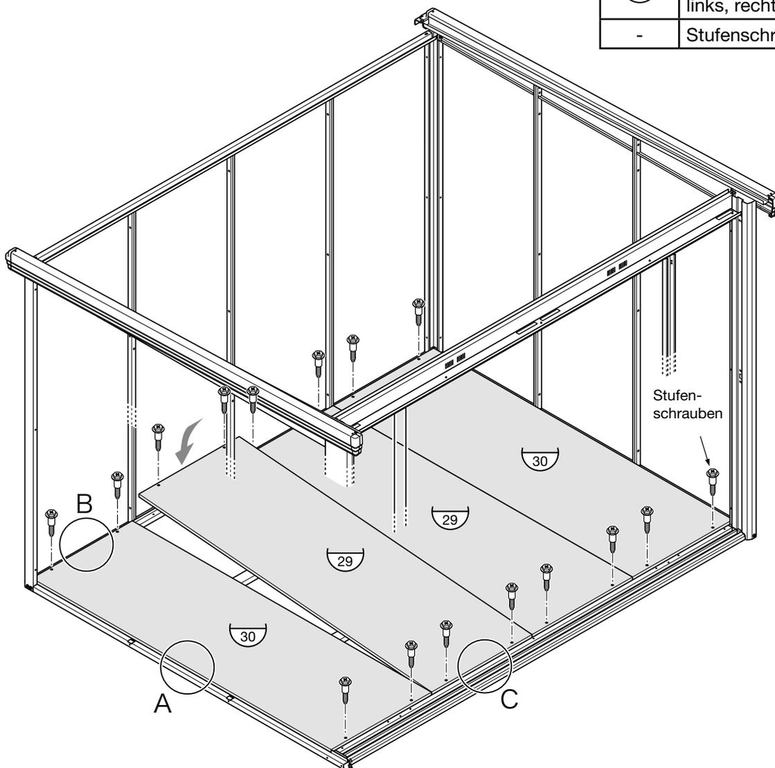
Der vordere Rand (C) der Bodenpaneele wird auf die Abflussrinne des Bodenrahmens deckend aufgelegt.
