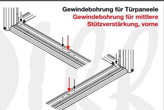
Die dritte Gewindebohrung, vom Eckposten ausgehend, wird für die Ausrichtung verwendet.
