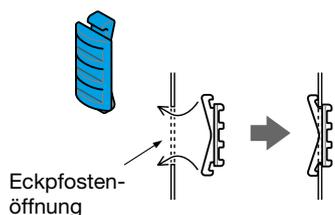
Gummipuffer zusammendrücken und in den Eckpfosten einsetzen.
