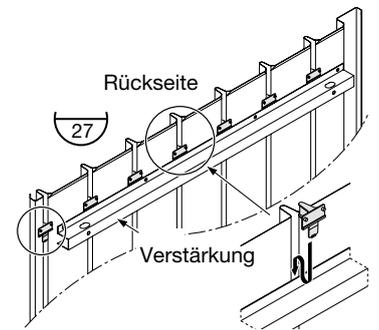
Achten Sie bei der Verlegung auf die Richtung der Dachpaneele, damit sie nicht verkehrt herum verlegt werden. Diese Dachpaneele haben eine Neigung, damit das Regenwasser nach hinten ablaufen kann.
