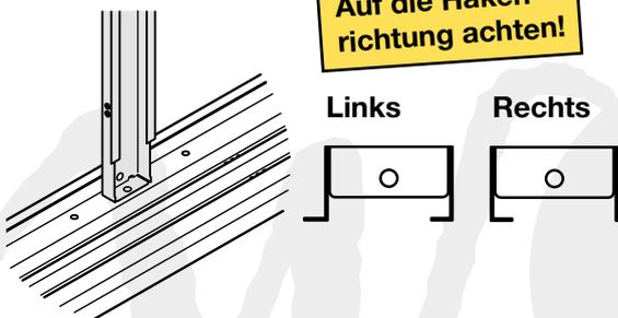
**Nach links öffnende Tür:** Bei der Montage wird das Oberteil des Pfostens für die Öffnung der Tür nach links umgedreht und nach der mittleren Bohrung des vorderen Bodenrahmens (01) ausgerichtet.
