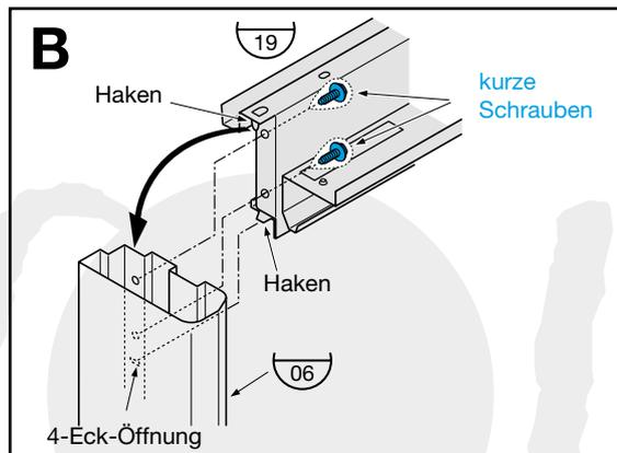
Der obere Haken des vorderen oberen Rahmens wird am Rand des vorderen linken Eckpfostens eingehängt. Der untere Haken des vorderen oberen Rahmens wird in die 4-Eck-Öffnung des vorderen linken Eckpfostens eingesteckt. Zum Schluss wird der vordere obere Rahmen und der vordere linke Eckpfosten mit den kurzen Schrauben verschraubt.
