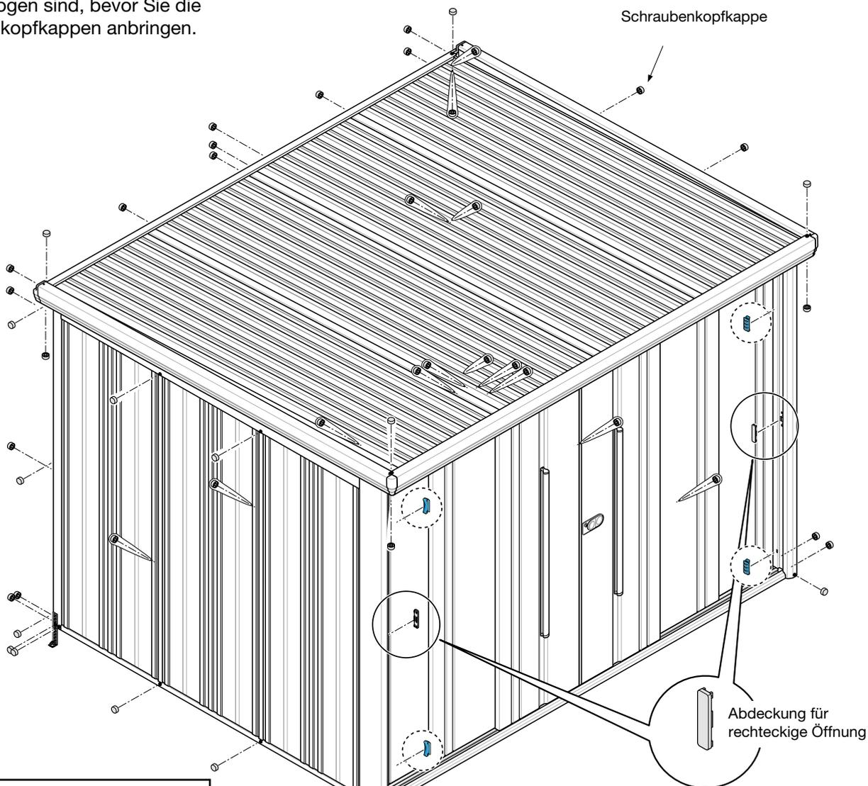
Die Gummipuffer an den vorderen rechten und linken Eckpfosten befestigen.
