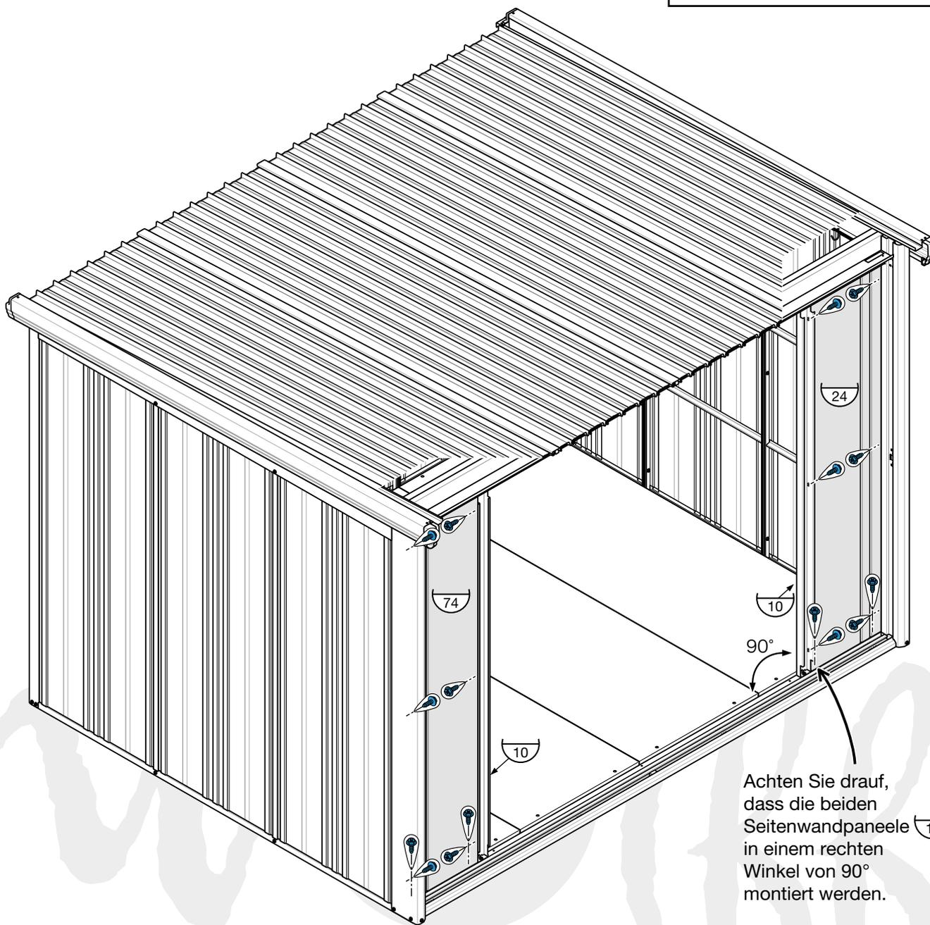
Achten Sie drauf, dass die beiden Seitenwandpaneele
