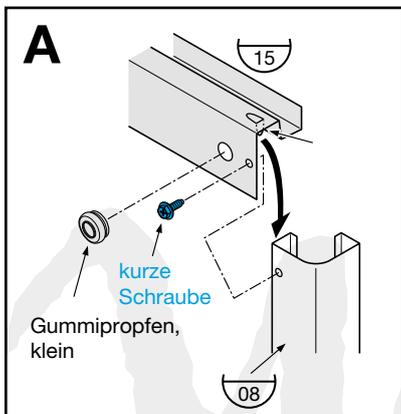
Der Haken des hinteren oberen Rahmens wird an den Rand des hinteren linken Eckpfostens eingehängt, dann wird der hintere obere Rahmen und der hintere linke Eckpfosten mit einer kurzen Schraube verschraubt.
