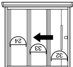
Austausch der Laufradeinheit aus Metall samt der Türanschlagskappe und des Befestigungshalters für die links öffnende Tür. Die Nummern <sup>(32)</sup> und <sup>(24)</sup> drehen, sodass die Teilenummern auf dem Kopf stehen. Wenn man die Tür links öffnend montiert, werden die oberen und unteren Teile der vorderen und der hinteren Tür ausgetauscht: Laufradeinheit aus Metall, Türanschlagskappe und Befestigungshalter.
