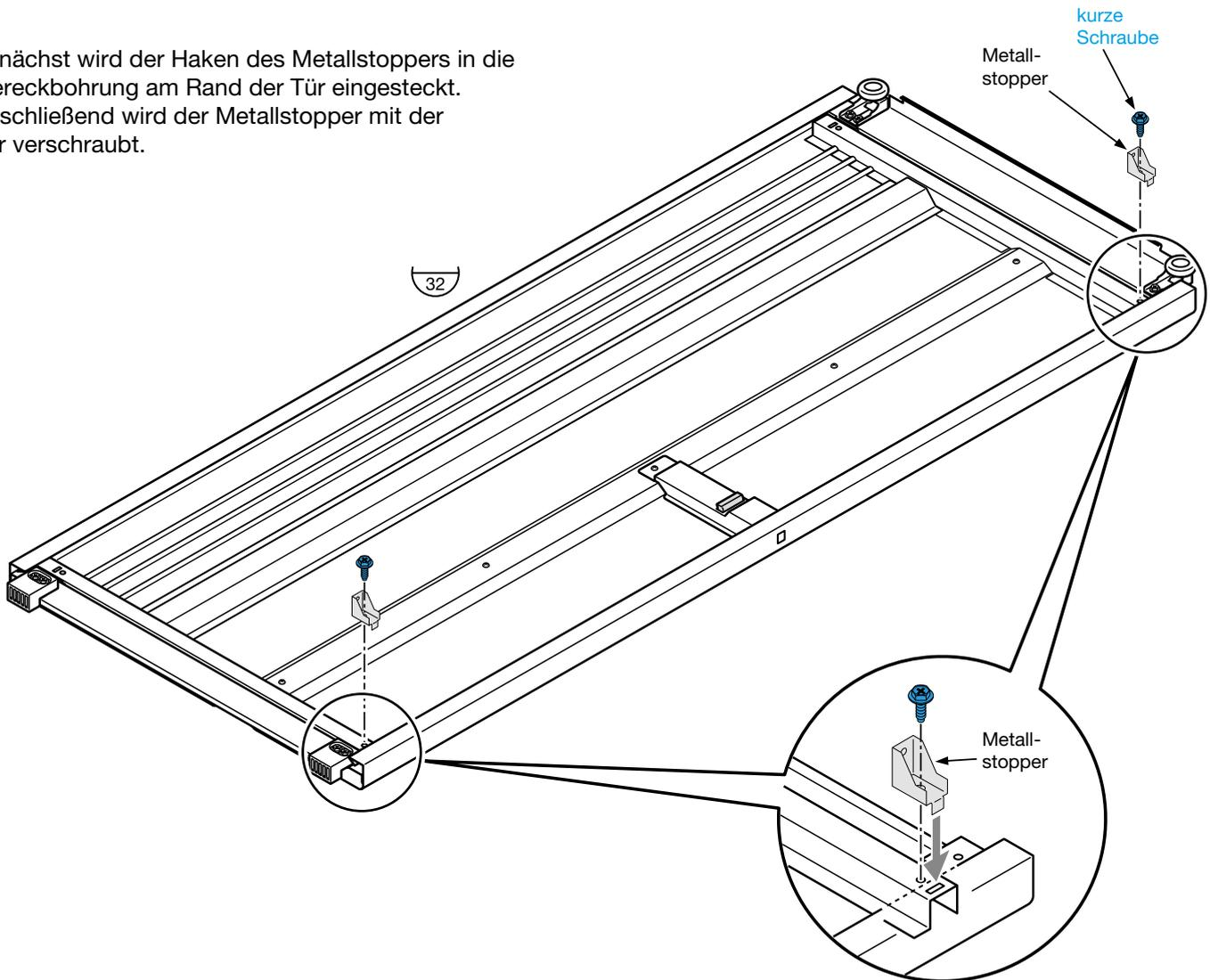
Die Türanschlagskappe in die Lafradeinheit aus Metall einstecken.
