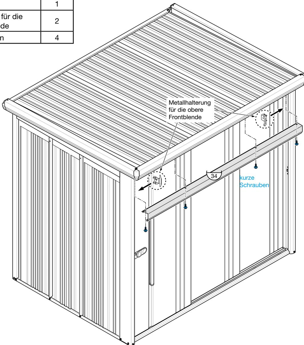
1. Die obere Frontblende wird zwischen den Eckposten für vorne eingefügt und an dieser provisorisch verschraubt.
