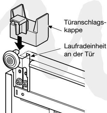
Für die nach rechts öffnende Tür wird Türanschlagskappe am rechten oberen Rand der Tür montiert.
