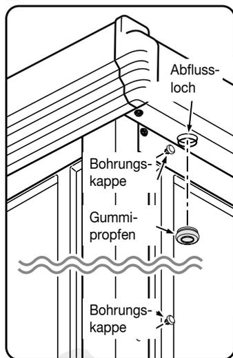
Die weitere Öffnung am Abfluss der Dachrinne, an die kein Fallrohr angeschlossen wird, wird mit einem großen Gummiropfen verschlossen. In die Bohrungen am Eckpfosten (Oben und Mitte) die Bohrungskappe einstecken.
