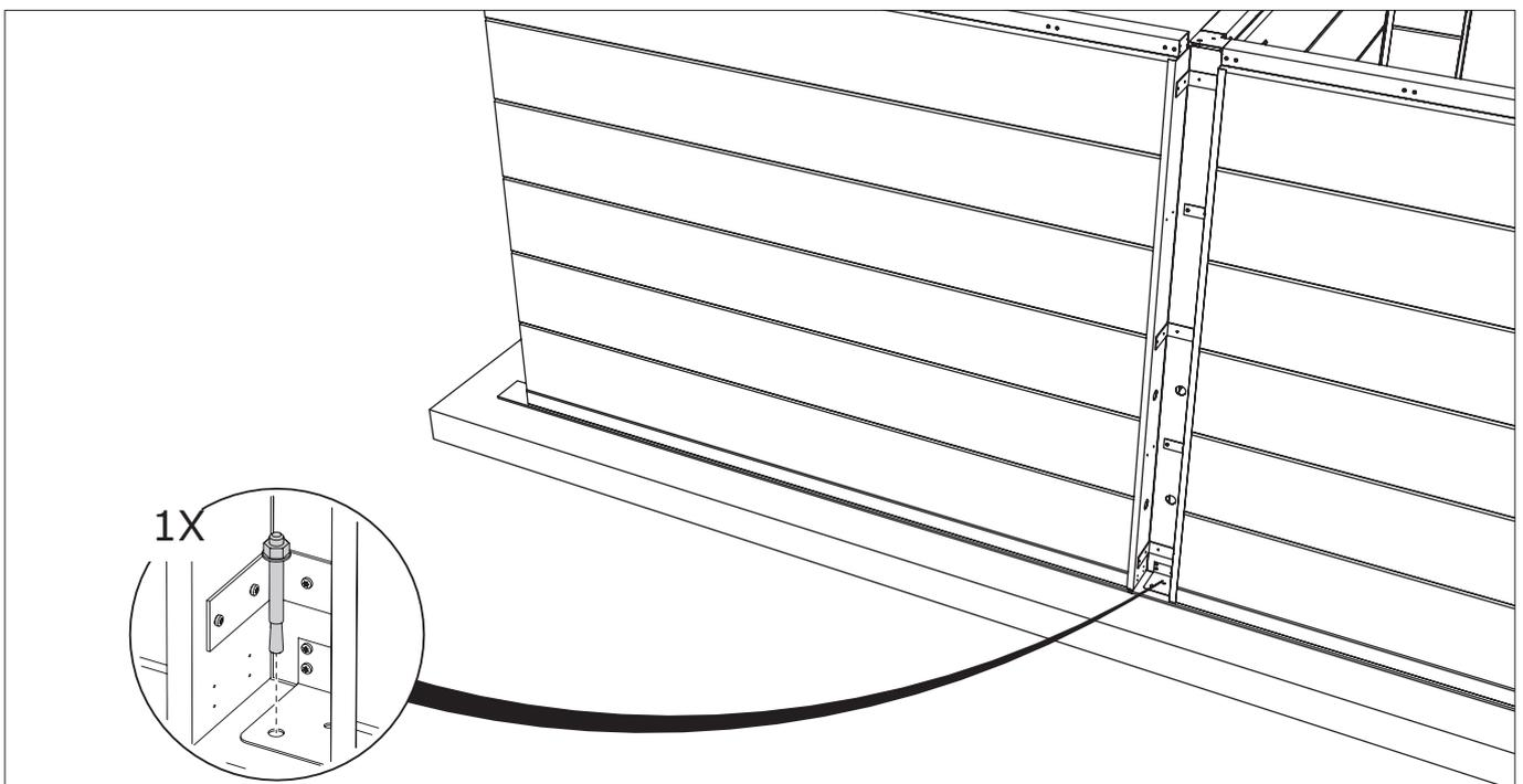
Exemple donné pour un sous-sol en béton. Fixer l'abri de jardin dans les règles de l'art.
